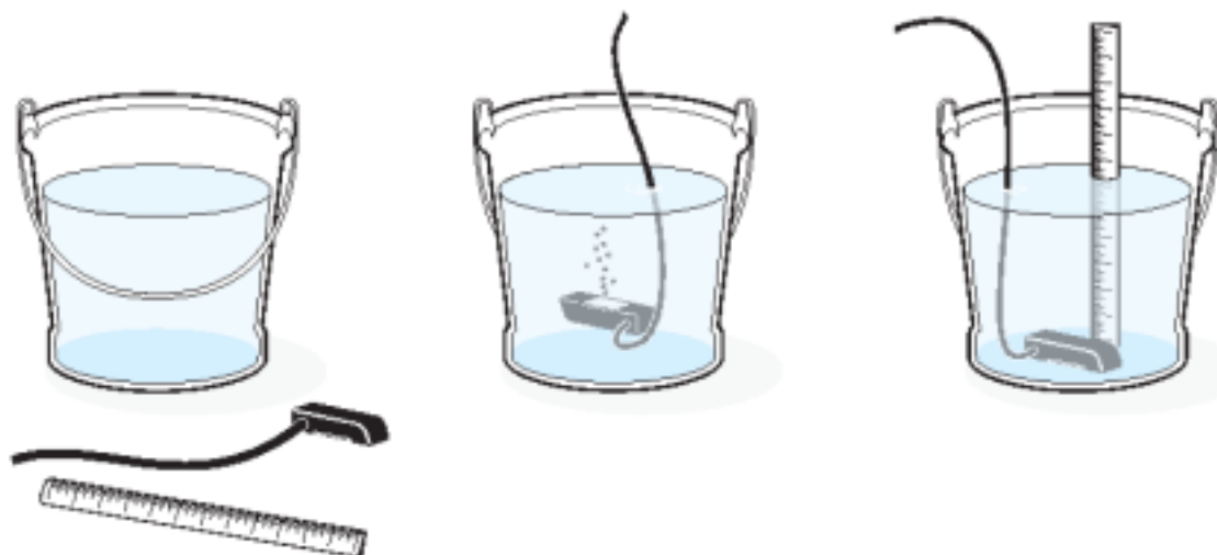
图 18 校准浸入式面积/速率传感器
